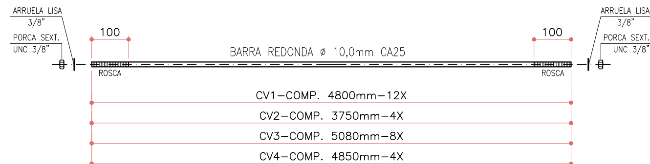
DETALHE TÍPICO DOS CONTRAVENTAMENTOS
